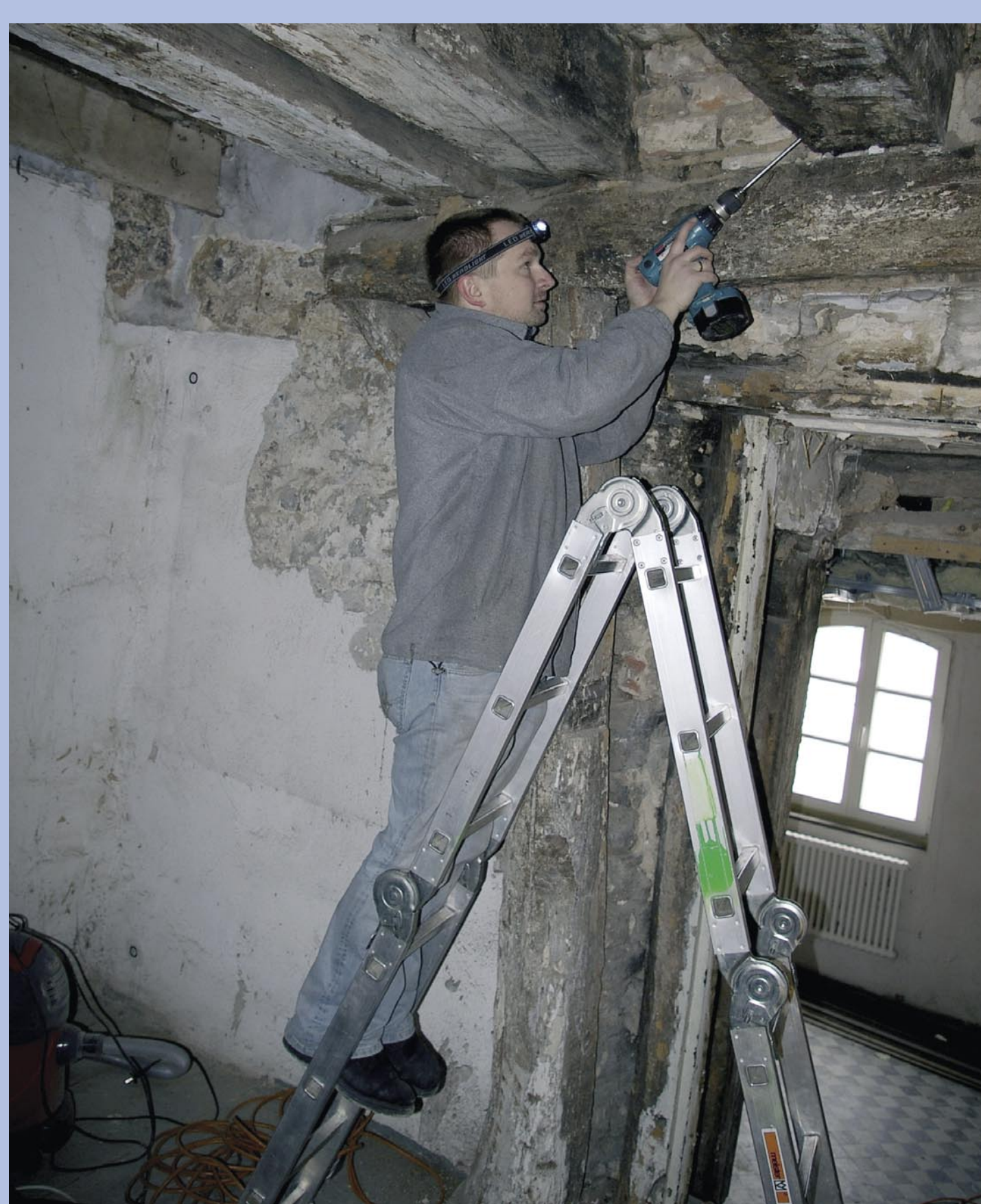
Entnahme von Bohrkernen zur dendrochronologischen Datierung am Huckinger Steinturm
