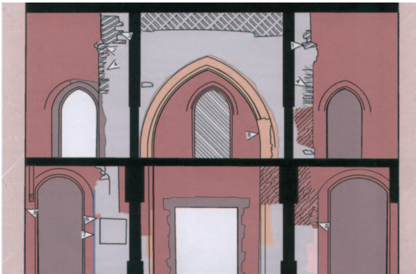
Kartierung der Mauerwerksbefunde an der freigelegten östlichen Außenwand des Turmes im Jahr 2006. Abb. 8
