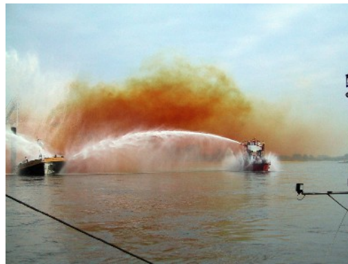
Löschboot, schlägt Nitrose Gase nieder
